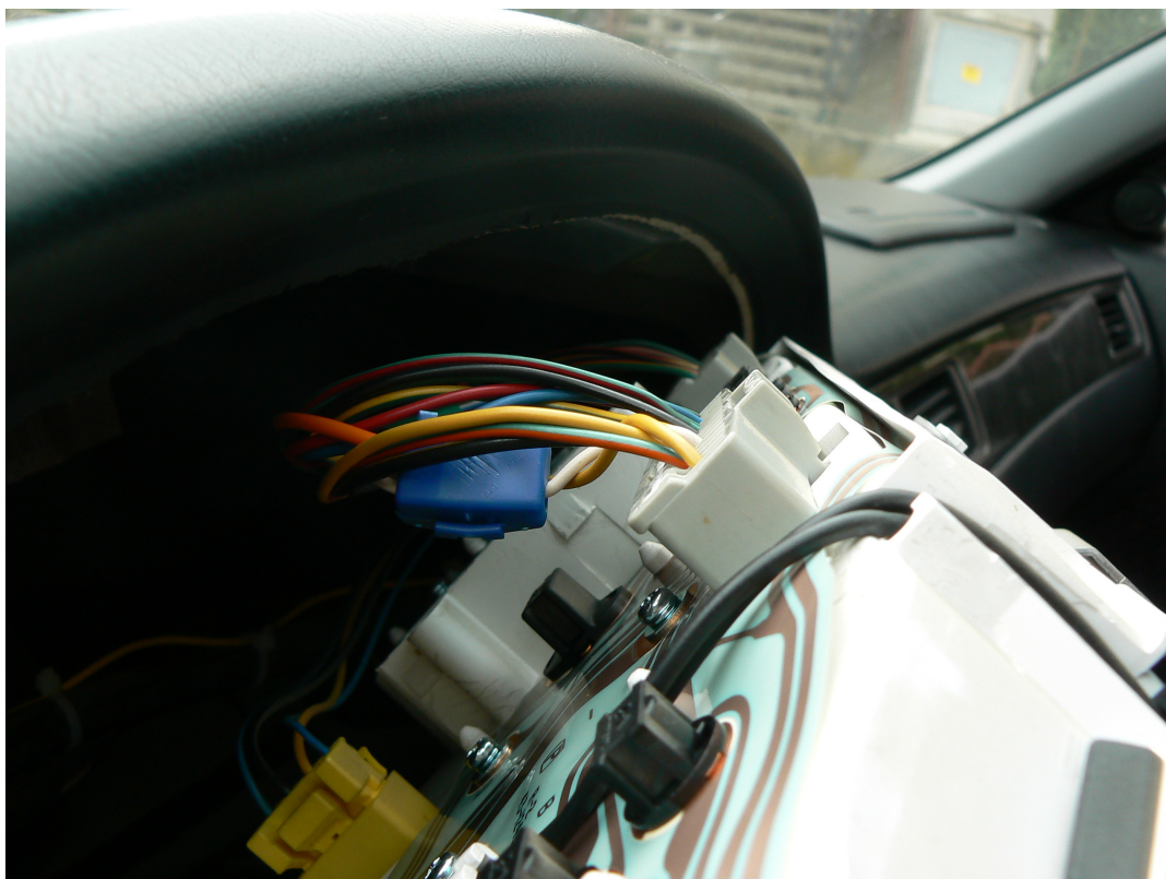
Připojení aktivačního pomocí svorky, která umožňuje napojení na kabel bez přerušení vodiče
